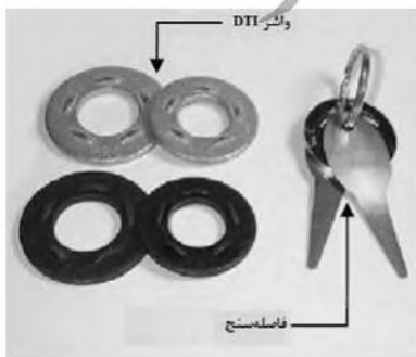
شکل ۴-۱۰-۷: فاصله قابل مشاهده در روش DTI پس از پیش‌تنیده کردن
